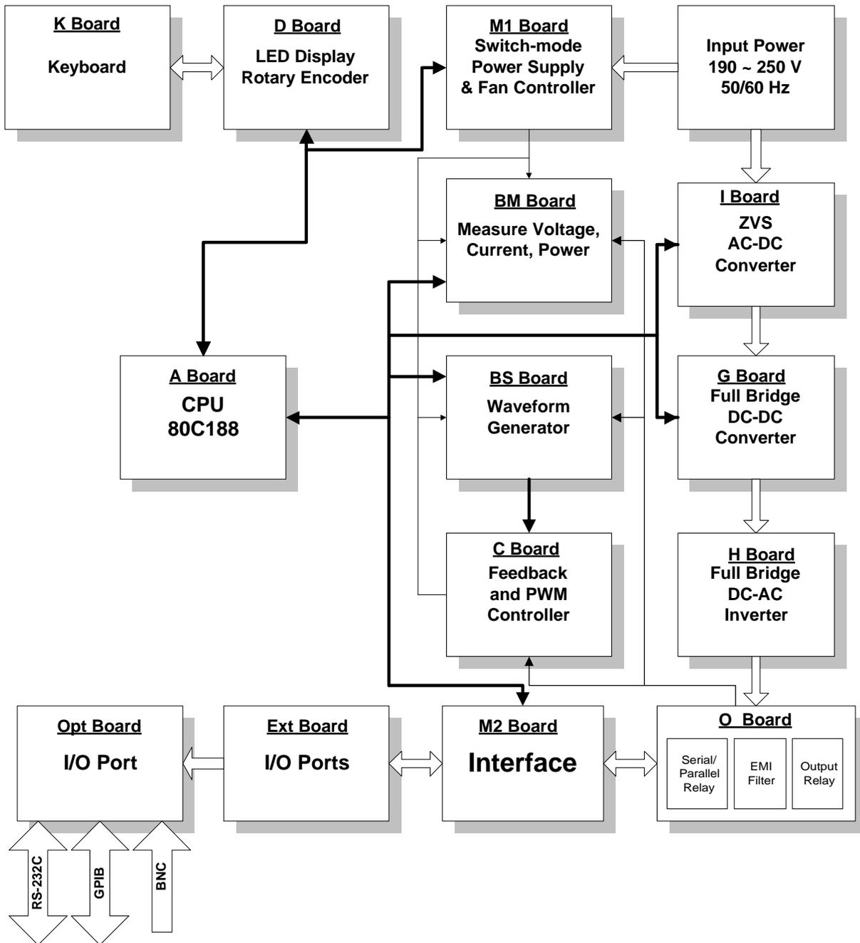
**Figure 4-1 EW 3001 Block Diagram**
